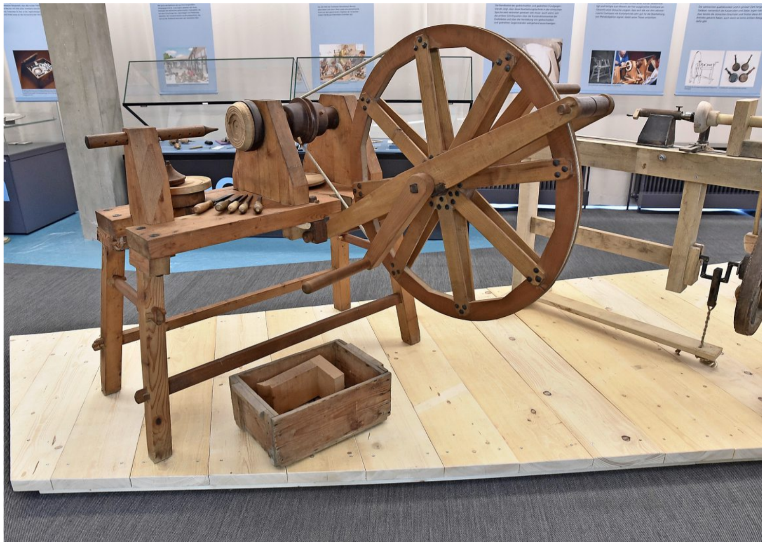
Die von Alfred Mutz rekonstruierte römische Drehbank mit Kurbelantrieb. Foto: Vindonissa-Professur / Jésus Duran
